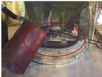
圖二 廢料添加至熔爐作業
