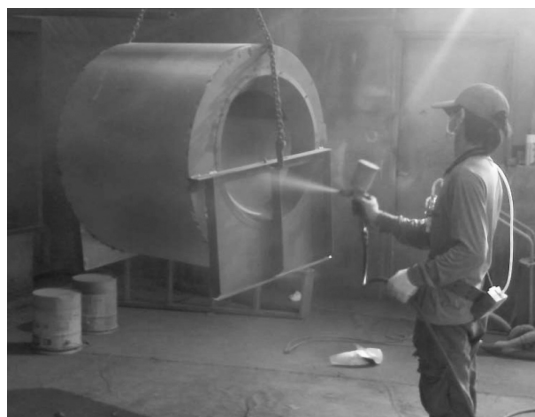
圖1 通風設備產品之防鏽噴漆作業現況
