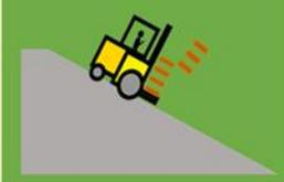
堆高機應依規定速限行駛，下坡路段應以倒車方式駕駛，以免車輛翻覆或物品飛落；行進中及行經交叉路口時應使用鳴聲警示，以提示其他勞工注意安全，夜間行駛時行車應有照明。
