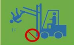
不得使其他勞工站立於堆高機之貨叉所承載貨物之托板、撬板及其他堆高機（乘坐席以外）部分；堆高機之修理或附屬裝置之安裝、拆卸等作業時，於機臂、突樑、升降台及車台，應使用安全支柱、絞車等防止物體飛落之設施。
