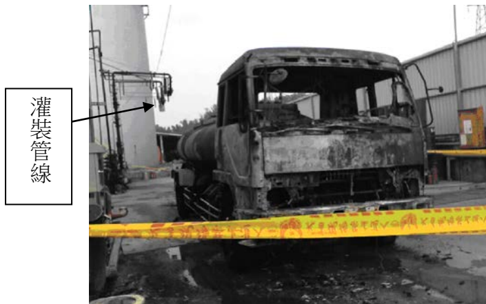
圖 4 受損後槽車近照-受爆震波影響，槽車離開灌裝區，前進約 10 公尺
