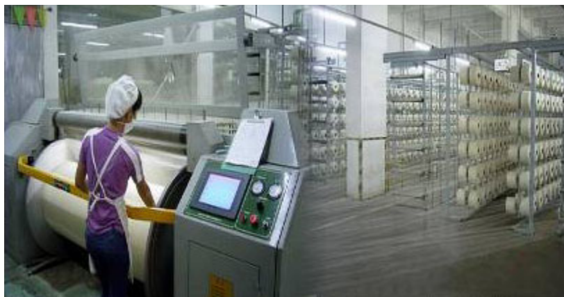
รูป 2.2 – อุปกรณ์ป้องกันอันตรายและปุ่มหยุดการทำงานฉุกเฉิน
