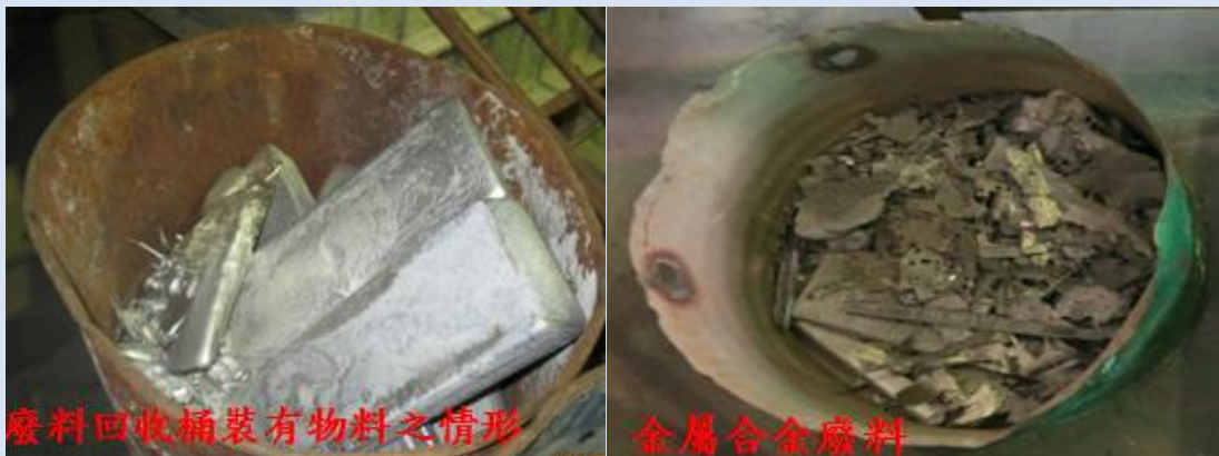
圖三 投料作業使用之廢料回收桶內裝滿不良鎂合金錠及金屬合金廢料，未注意廢料桶中有水瓶。
