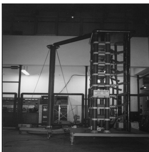
圖 7 衝擊電壓試驗
