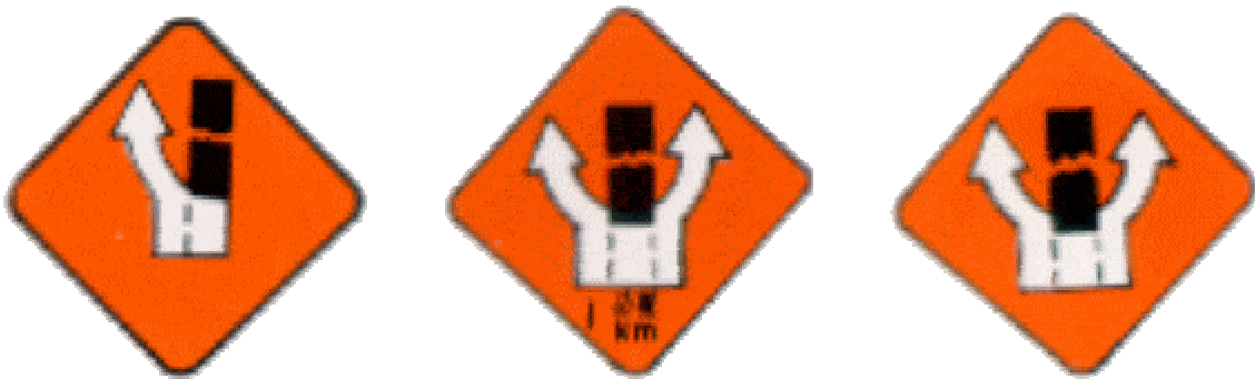
圖6 設置於施工路徑,傳達右車道封閉車輛改道之訊息
