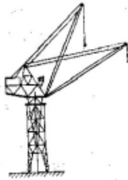
圖 1 固定式塔式起重機
