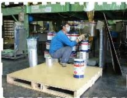
圖4 改善前：油漆給料口高度太低，員工工作時必需長時間蹲坐在矮凳上作業，造成作業員腿部血液無法回流而導致痠麻。
