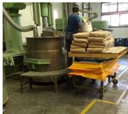
圖7 改善後：利用油壓裝置調整適合搬運的高度，物料少時可將推車高度調高，減少腰部及手部出力避免拉傷。
