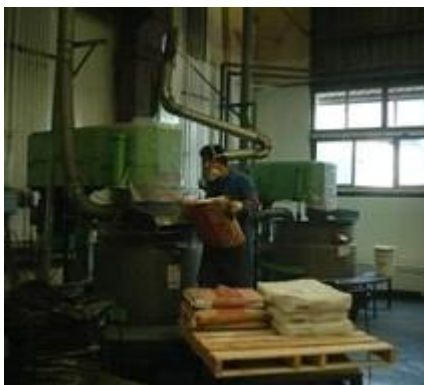
圖6 改善前：員工進行搬運作業時需彎腰抬舉重物，易造成腰部及手部間肌肉拉傷等症狀。
