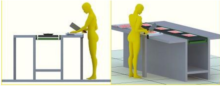
圖9 改善後：為解決手腕反震力問題，必須先增加工作台的強度，建議在砧板下方立一鐵柱，使作業員下剝的力量直接傳達至地面，而不會造成桌面的震動而產生極大的反震力傷害手腕。
