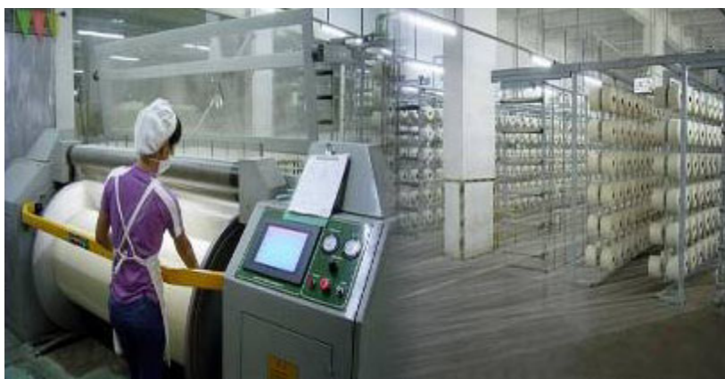
Hình 2.2 Lắp đặt tấm bảo vệ và thiết bị khẩn cấp
