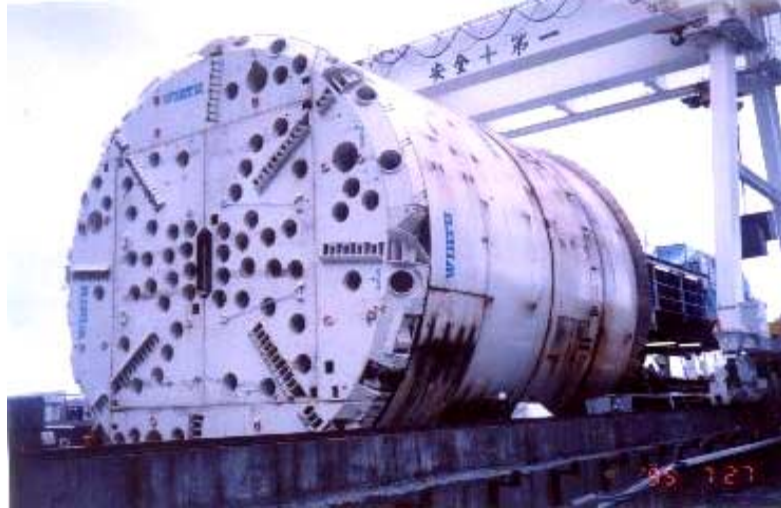
照片2 隧道鑽掘機(TBM)切削頭組裝 (資料來源：本計劃參與人員自行拍攝)
