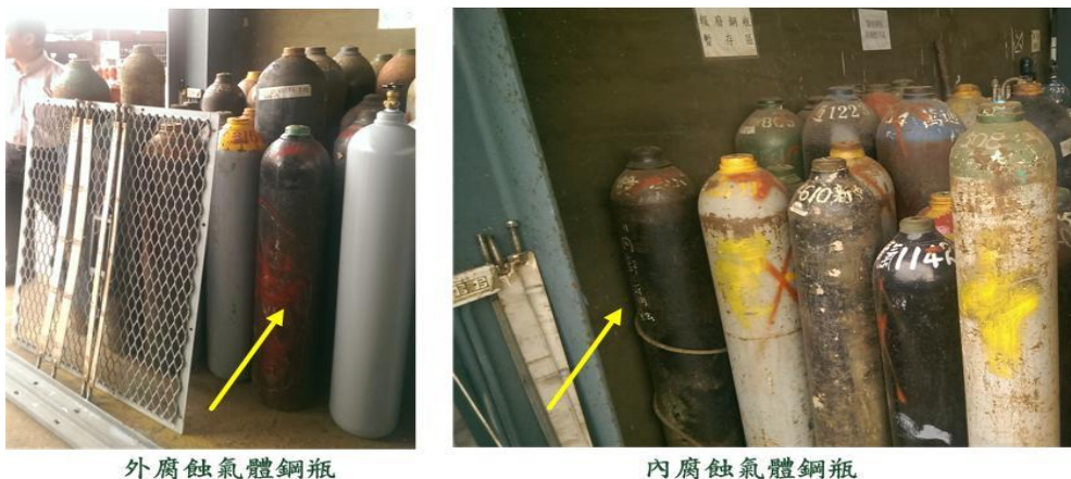
圖 17 氣體鋼瓶 A 鋼瓶外腐蝕與 B 鋼瓶內腐蝕照片
