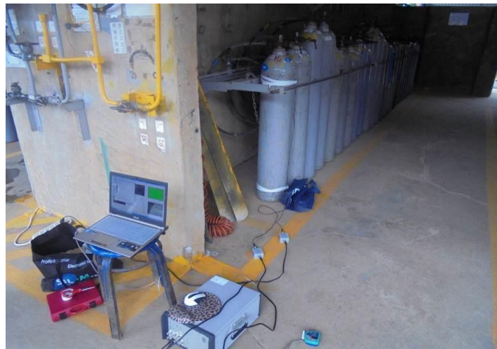
圖 18 氣體鋼瓶音洩實驗架設
