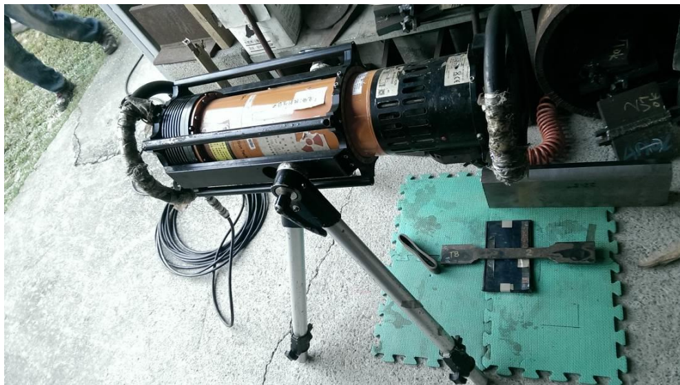
圖 61 費利西蒂效應實驗試片：銲道 RT 檢測
