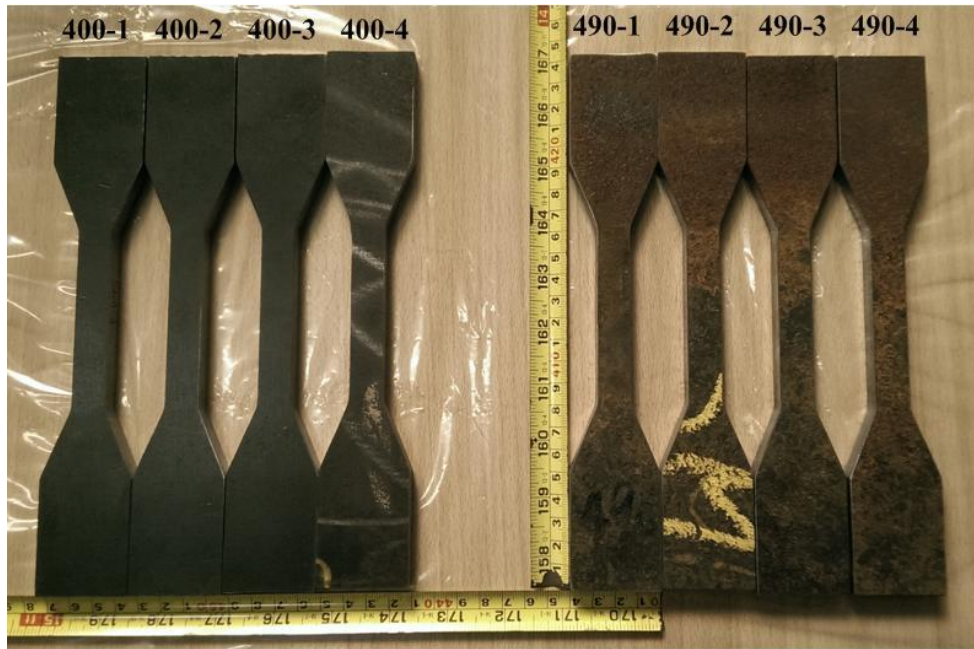
碳鋼S400靜態拉力試驗試片
