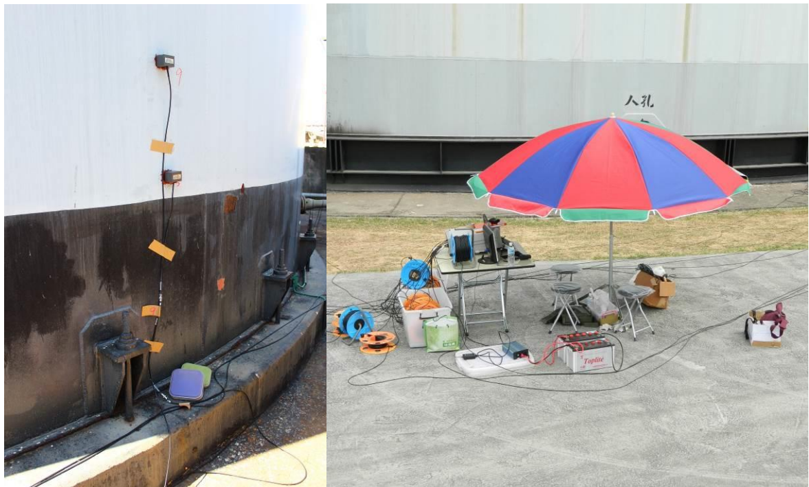
圖 98 現地儲槽音洩實驗量測
