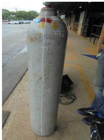
圖 19 氣體鋼瓶音洩傳感器架設位置圖
