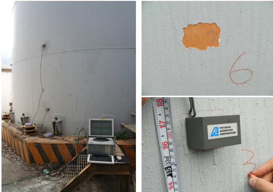
圖 112 音洩檢測系統與傳感器安裝
