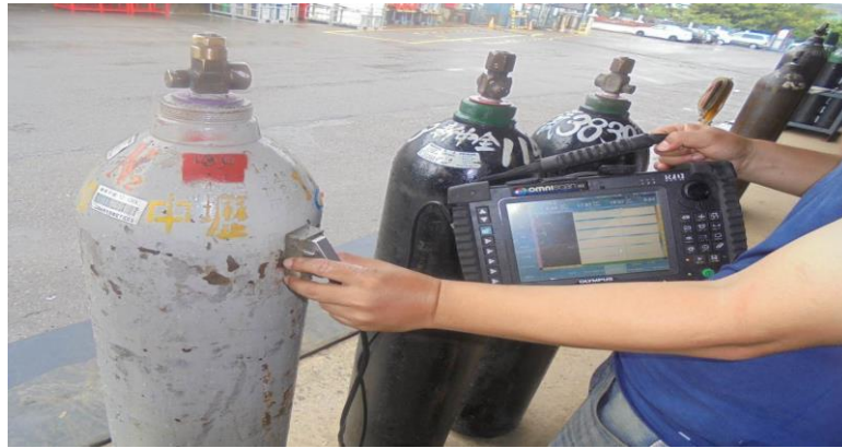
圖 22 氣體鋼瓶相位陣列超音波瓶身壁厚 B 掃描架設
