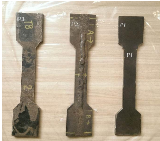
圖 60 費利西蒂效應實驗試片，P1 母材、P2 縱向銲接、P3 橫向銲接
