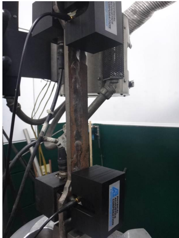
圖 69 縱向銲接試片 P2 拉伸試驗與音洩訊號量測
