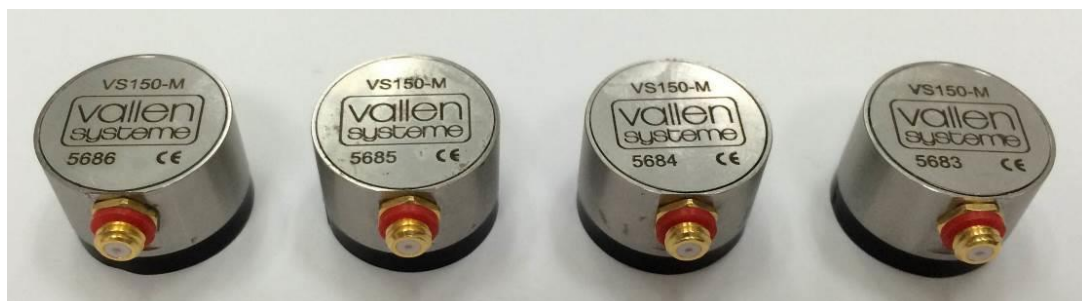
圖 4 音洩傳感器 VS150-M
