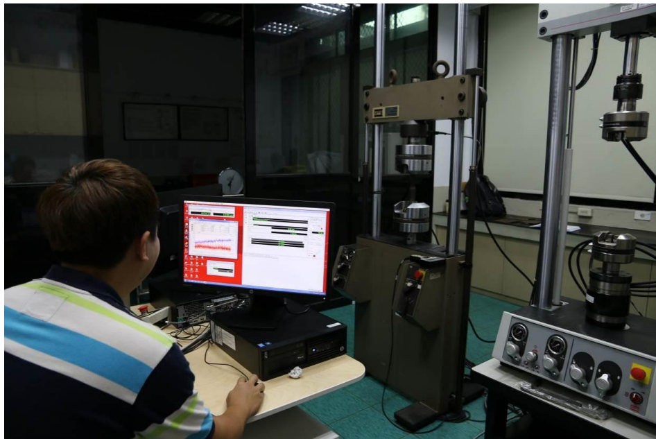
圖 65 材料拉伸試驗機操作情形
