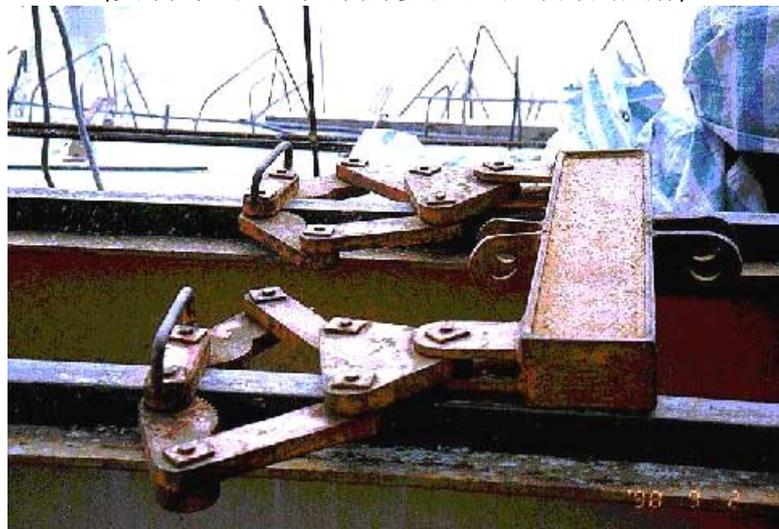
照片2 懸臂式施工工作車之安全抓鉤
