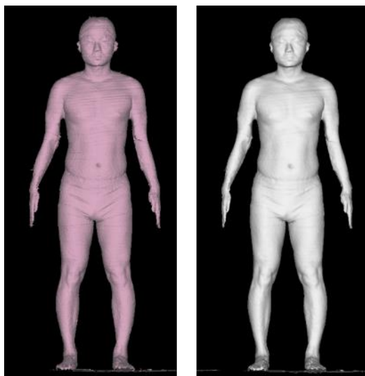
圖 45 網格平滑化前 (左) 和網格平滑化後 (右)
