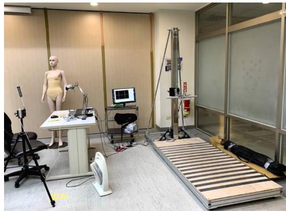
圖 55 力量量測之設備
