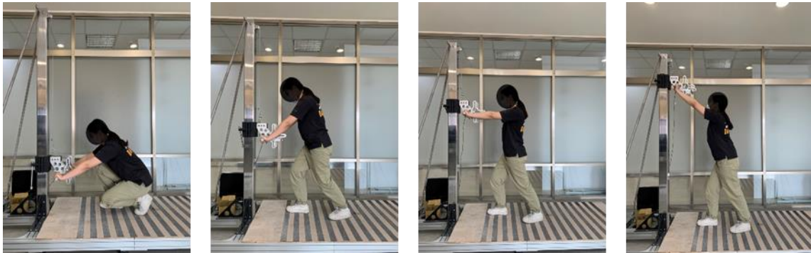
圖 53 不同施力高度雙手之推力量測示意圖 (施力高度由左至右依序為 40cm、80cm、120cm、160cm)
