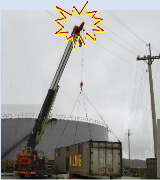
圖一 起重機吊掛時，吊臂觸碰高壓電線造成勞工感電死亡。
