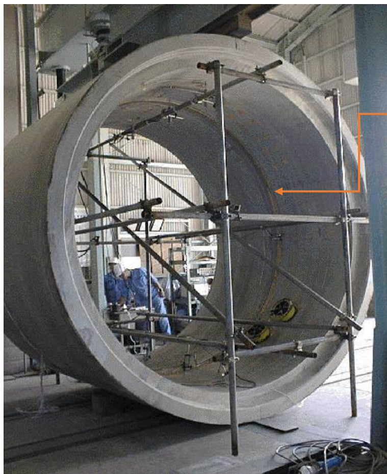
圖一 光纖感測器在大口徑導管的圓周應變應力的分布測試應用
